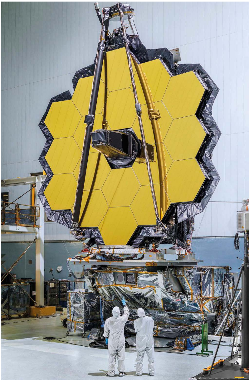
Abb. 3 Zusammenbau des Hauptspiegels des James-Webb-Teleskops im November 2016. Die Fläche des Hauptspiegels beträgt mehr als 25 m 2 und ist etwa 5,5 mal größer als beim Hubble-Space-Teleskop. (NASA)
